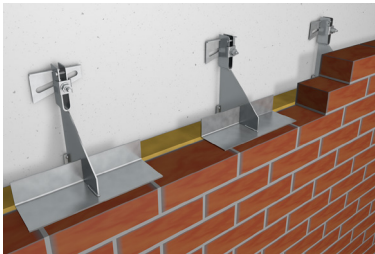
▲ EK-L Mit längerem Auflager Laststufen: 3,5 kN–25 kN, Wandabstände: 20 mm–370 mm, Höhenjustierung: \pm 25 mm
