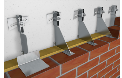
▲ EK-W Die flexible Lösung bei kleinen Lasten Laststufen: 1,8 kN–3,5 kN, Wandabstände: 20 mm–370 mm, Höhenjustierung: \pm 25 mm
