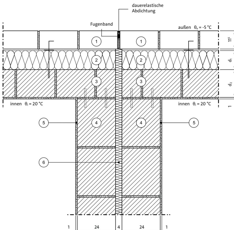
Grundsätzlich sind Bauteilfugen auch in der Fassade aufzunehmen. Dabei ist auf die freie Beweglichkeit über den gesamten Querschnitt der Verblendfassade zu achten. Die Mindestbreite solcher Dehnungsfugen sollte 15 mm nicht unterschreiten.
