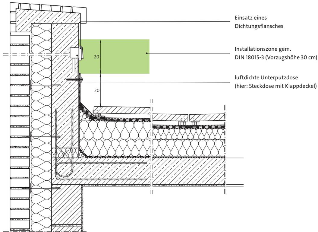
**VERTIKALSCHNITT** Attikaanschluss – Dach begehbar, thermisch getrenntes Betonelement als Brüstung,
