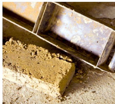
▲ Formung im Handschlagverfahren.
